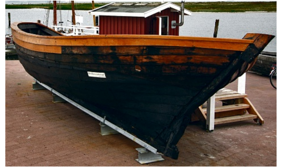
Die Quase hat eine Bünn, in der die Fische lebend an Land gebracht wurden. HENZE
